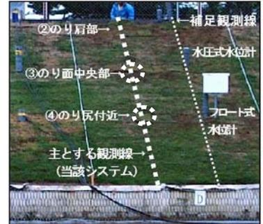
写真-1 土研での浸透モニタリング状況
