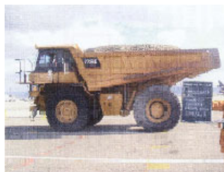
写真-1 46tDT載荷試験状況
