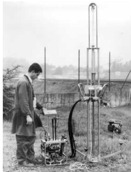
図-1 小型動的静的貫入試験装置 (DYNASTAR, Tecnotest 社, Italy)
