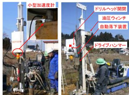
(a) 連続打撃貫入試験 (b) 標準貫入試験
