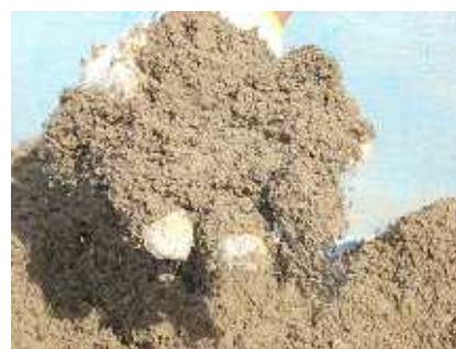
写真-3 短繊維補強土
