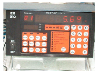
写真 2 水分計の設置状況 (上)センサー部、(下)モニター部
