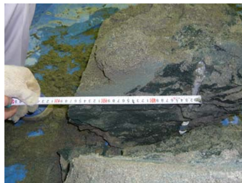
写真-3 改良体切出し状況 (700%)
