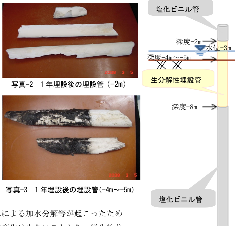
図-6 現場分解実証試験状況
