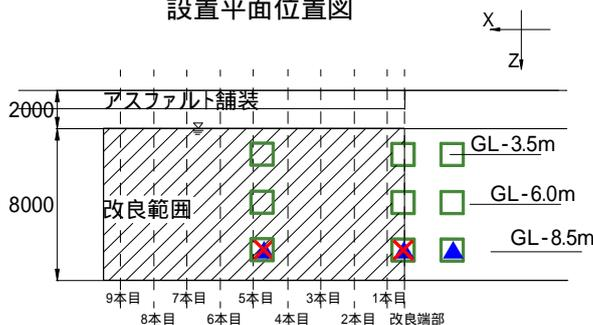
図 - 2 孔内水平載荷試験と間隙水圧計設置断面位置図
