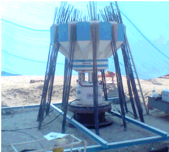
図-2 静的載荷試験状況
