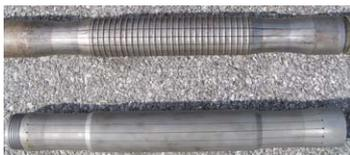
写真-1 SBIFT 試験器周面の形状 (上段: ラフ, 下段: スムーズ)
