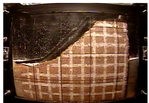
図-2 崩壊状況 (Sr45R30)
