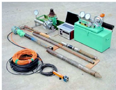
写真-1 SBIFT試験装置
