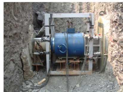
写真－3 载荷試験（水平载荷）
