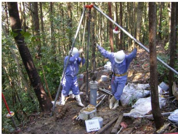
写真-4 重錘落下による貫入状況
