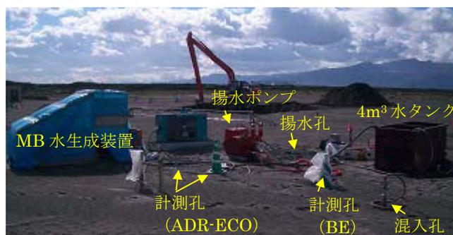
写真-1 実地盤 MB 水混入実験状況
