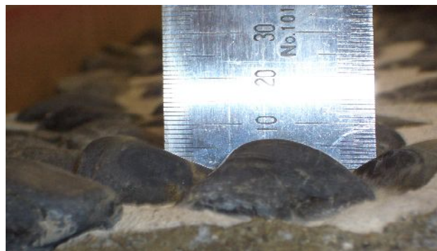
図-3 水平領域の河床凹凸模型の断面図
