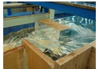
写真3 洪水時の流況 (屈曲型の場合)
