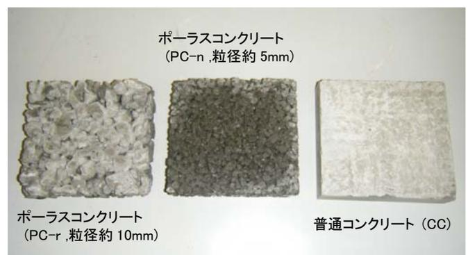
図-1 本実験で用いた三種類の供試体
