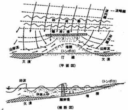
図3 離岸堤によるトンボロの形成<sup>1)</sup>
