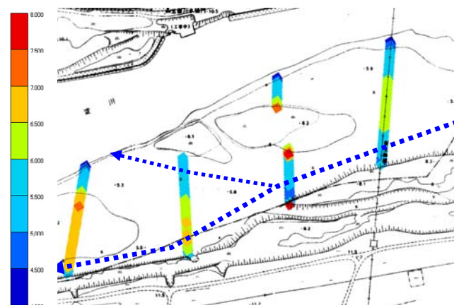
図4 各測線の地盤高と二次流路
