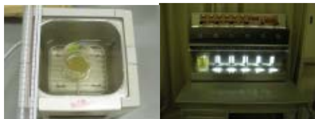
写真-1 投入前分散 写真-2 ジャーテスターによる攪拌
