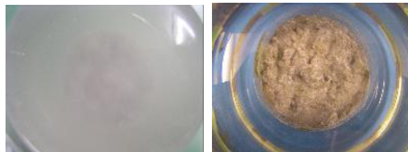
写真-1 転炉系スラグおよび混合材料の海水投入状況
