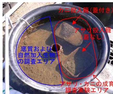
写真-3 実験エリアの配置
