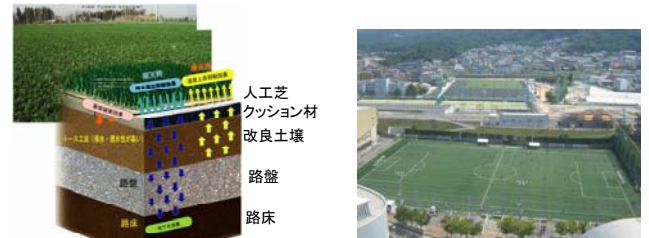
図-1 新型人工芝グラウンド模式断面図 写真1 人工芝グラウンドの全景
