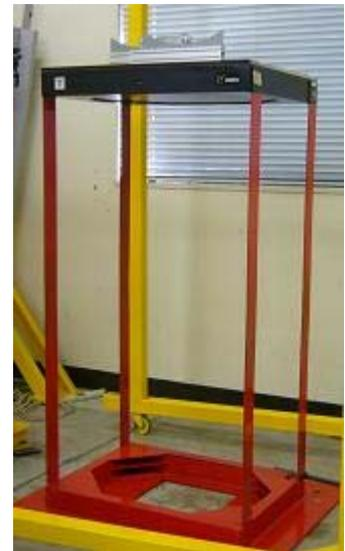
図-1 ラーメン構造模型
