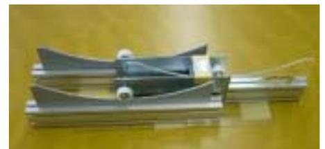
図-2 クレイドル型制振装置
