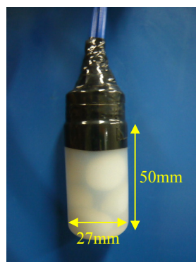
写真-1 放電カートリッジと試験体の一例
