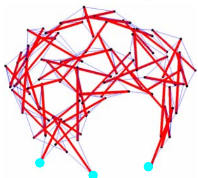
Fig.5 ドーム状の大型テンセグリティの決定形状
