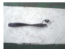
Fig.5 切断コイルが光ファイバー に食込んでいる様子
