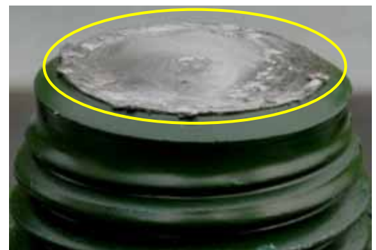
写真-6 仕上げ前のピンテール破断跡
