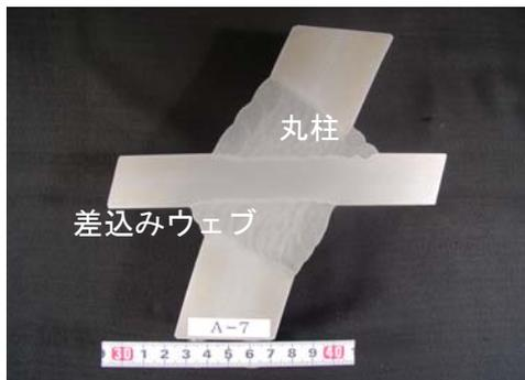
写真-2 丸柱スリットと差込みウェブのマクロ試験(試験体A: MA-1)
