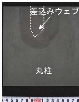
写真-3 丸柱スリット止り部のスライスマクロ試験(試験体A: MA-2)
