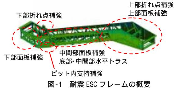
図-1 耐震 ESC フレームの概要
