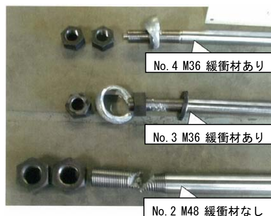
写真-1 実験後のボルトの状況
