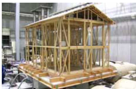
図1 1/5 スケールミニチュア木造住宅
