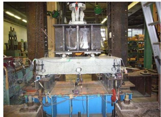
写真-3 はり模型による疲労試験の状況
