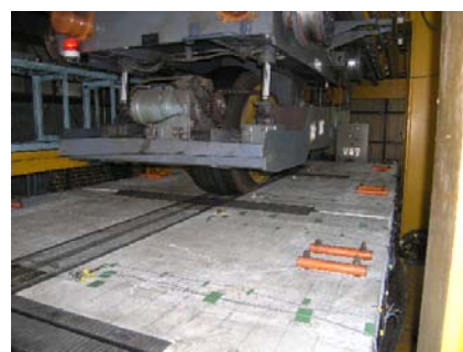
写真-2 輪荷重走行試験状況
