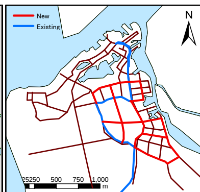
図-5 道路・水道管路図(案)
