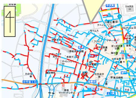
図1 下水道管路の被害有無
