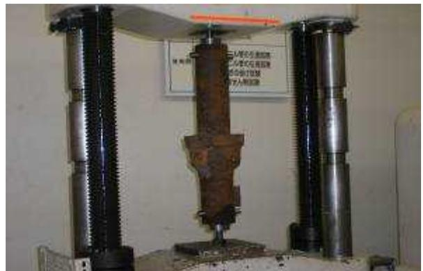
図2 引張試験の様子
