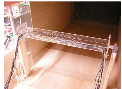
図2 風洞内に設置した圧力模型
