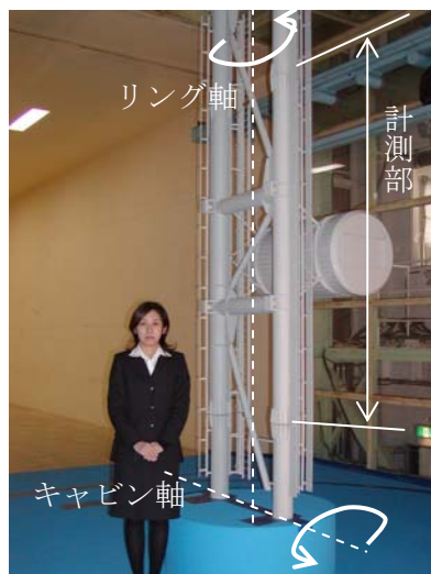
図2 大型部分模型（縮尺 1/7.85）
