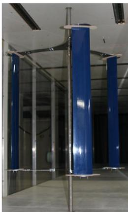
写真-1 垂直軸型風車
