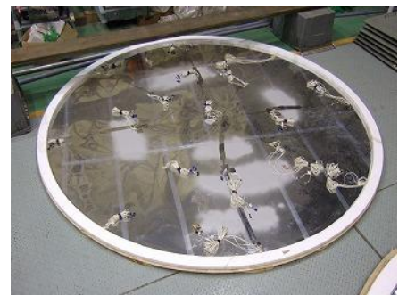
図 2 浮屋根模型概観
