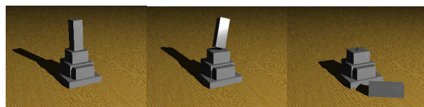
図5 モデル3の解析結果(左から、震度6弱後、6強中、7後)
