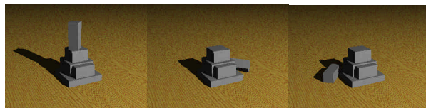
図3 モデル1の解析結果(左から、震度6弱、6強、7後)
