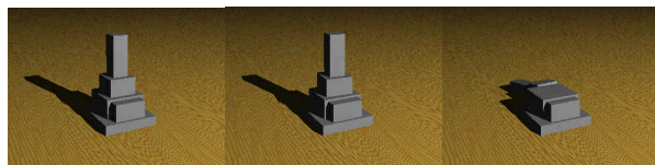
図4 モデル2の解析結果(左から、震度6弱、6強、7後)
