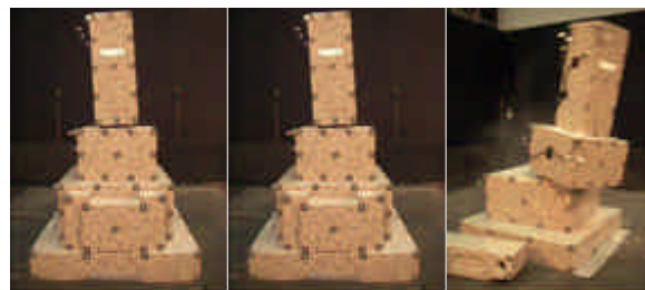
(a)震度 6 弱加振中 (b)震度 6 強加振後 (c)震度 7 転倒時
