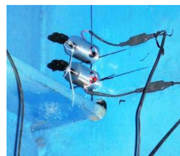
図-4 応力聴診器による計測
