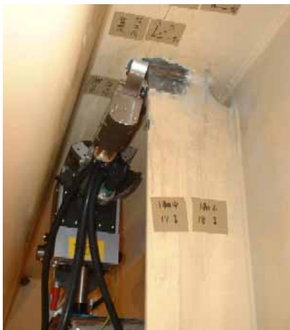
図4 X線応力計測状況 (Xstress3000, G2 改ゴニオメータ)
