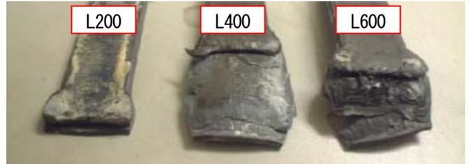
写真5 短冊試験後(底面テフロンパウダー塗布)
