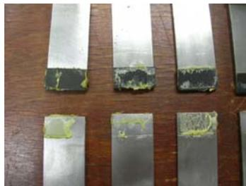
写真3 引張せん断試験後
