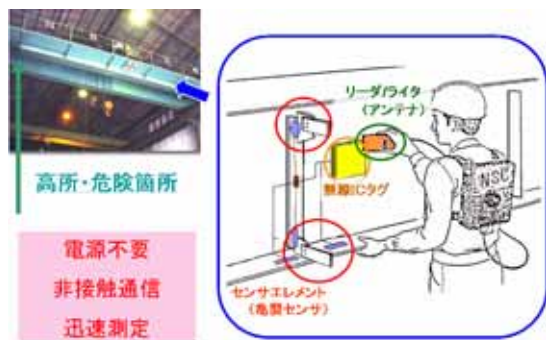
図1 無線センサシステム概要図
