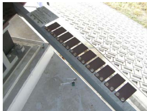
写真-2 曝露試験片の設置状況
