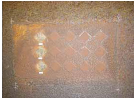
写真 1 ワッペン試験片 3 枚回収時
